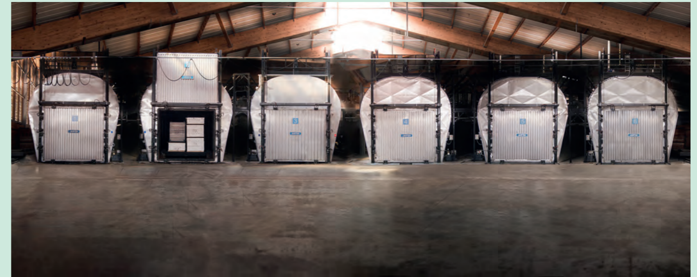
Above: Thermal modification kilns (Jartek)
